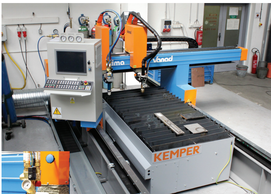
Vanad PROXIMA a na obrázku vlevo autogenní hořák FIT+Three
