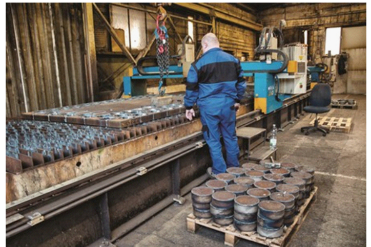
V Obchodní společnosti TVK využívají Lissmac na odstranění otřepů výpalků vyráběných na strojích Vanad 2000.
