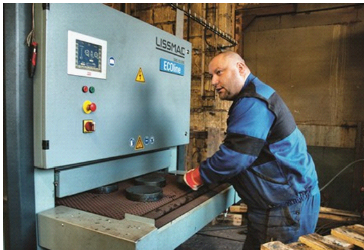
Dříve výpalky očišťoval brusič ručně. Dnes zvládá pomocí stroje Lissmac výpalky odstranit obsluha pálicích strojů.
