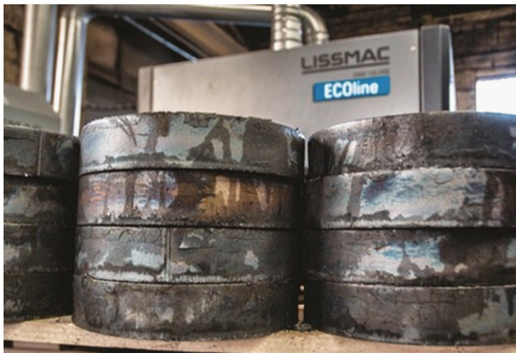
Strusku na výpalcích po plynovém pálení spolehlivě odstraní Lissmac SMD 133 DRE.
