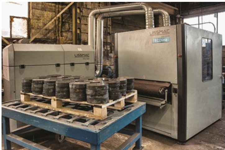
Stroj Lissmac SMD 133 DRE je vhodný na odstranění otřepů a strusky po plynovém pálení.
