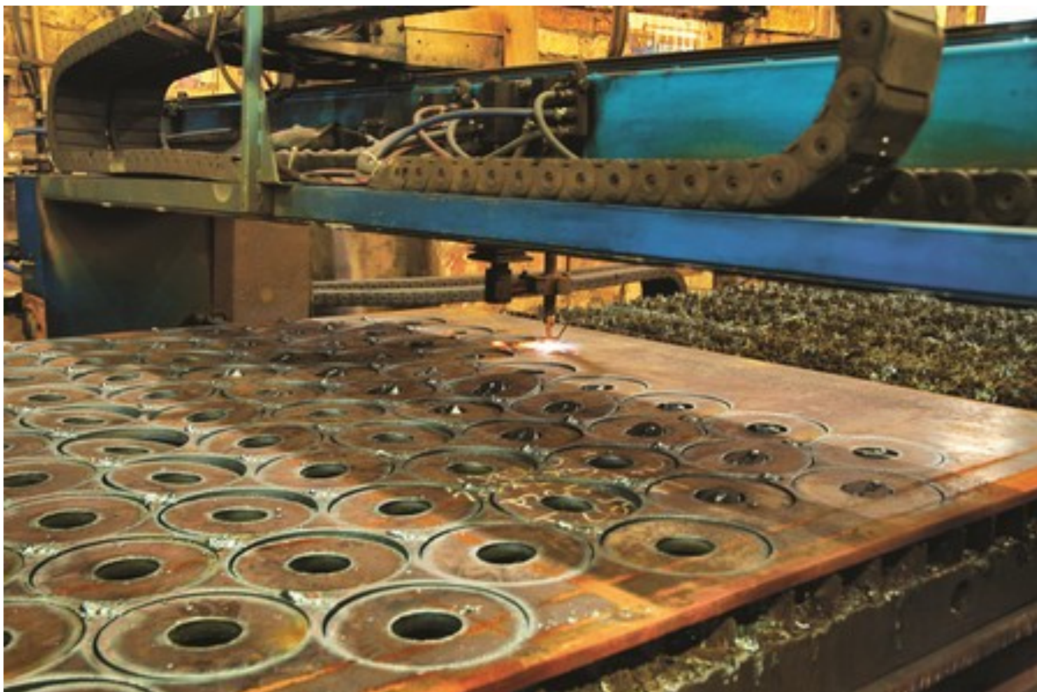
V Obchodní společnosti TVK využívají dva portálové pálicí stroje Vanad PROXIMA25/60, pohybující se po společné koleji, zpracují měsíčně zhruba 450 tun plechu z nelegované konstrukční oceli.
